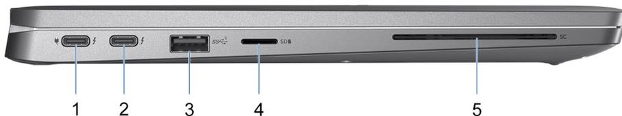
1. Thunderbolt 4-Anschluss mit DisplayPort Alternate-Modus/USB-Typ-C/USB4/Power Delivery
